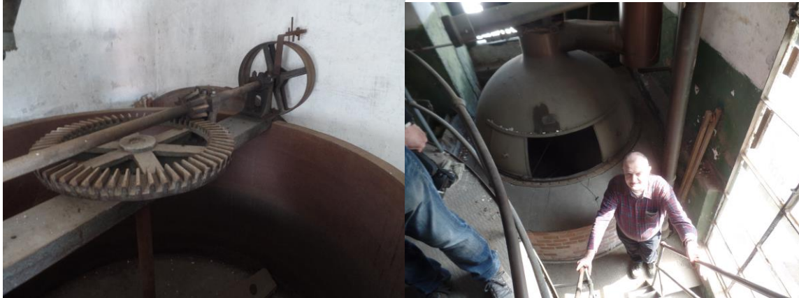
Der Maisch- und Läuterbottich aus dem Jahr 1891 (links) und die 30 hl Sudpfanne (rechts) in der Brauerei zum Schiff.
