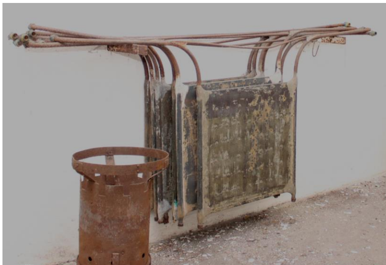
Abb. 4: Kühlplatten für offene Gärbottiche (ARS 2021)
