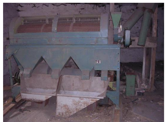
Abb. 21: Ein Sortierzylinder (?) für Getreide oder Rundsamen (Trennung in drei Größen). Die Maschine aus dem Jahre 1958 stammt aus dem Mühlenbau Dresden
