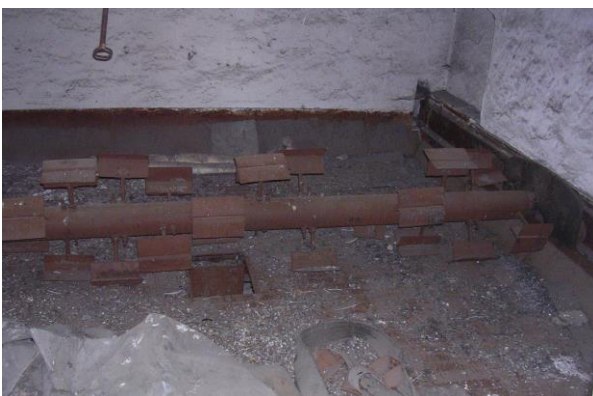
Abb. 20: Die mechanischen Malzwender in der Malzdarre
