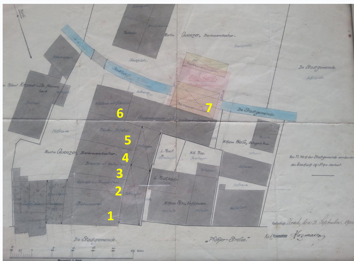
Abb. 1 Übersichtsplan des Betriebsgeländes der Brauerei Quenzer in der Uracher Innenstadt von 1904, mit Bierbrauerei (1), Malzdörre und Treppenhaus (2), Brauerei mit Kesselhaus (3), Pferde- und Viehstall (5), Kühlhaus mit Gärkeller (6) und Tropfeisgerüst, wird abgebrochen (7)
